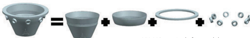
NX CAD används för att dela upp geometrin
