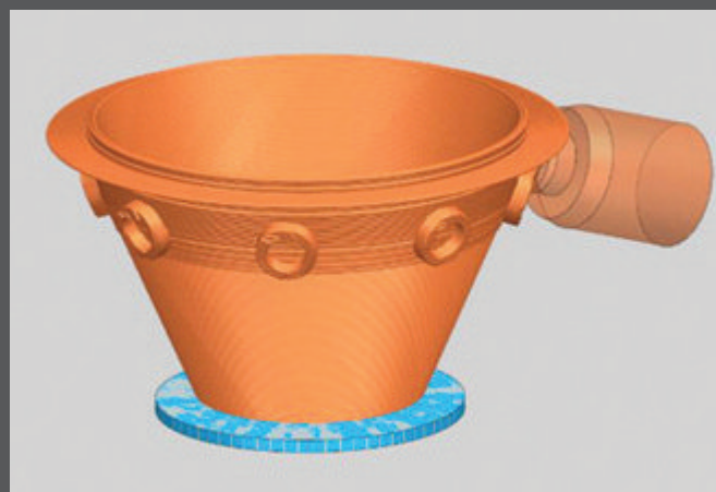
Simulering av den additiva byggprocessen med hjälp av In Process Workpiece (IPW)
